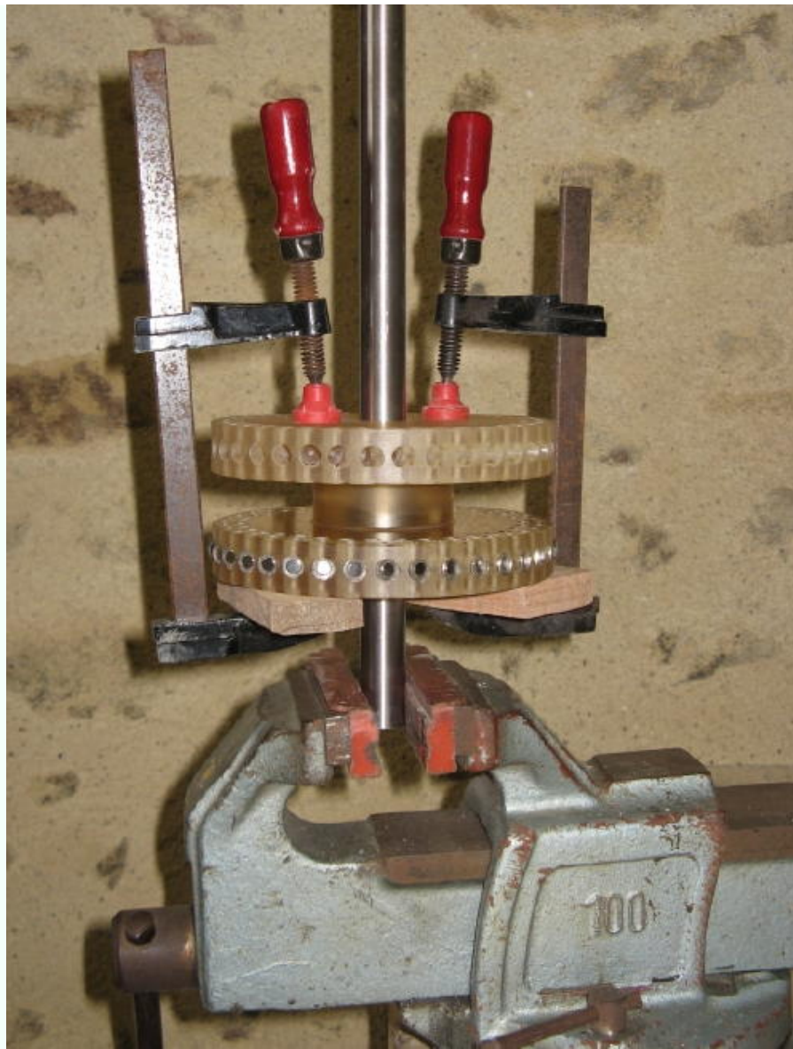
Collage et pressage d'un intercalaire à son rotor
