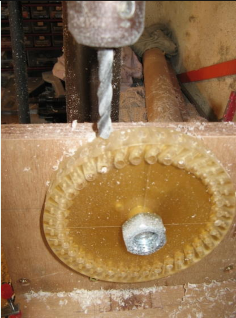
Perçage du rotor en cours
