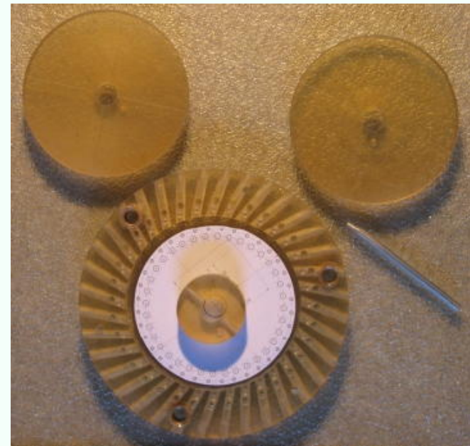
Stator et intercalaires terminés, rotors en préparation
